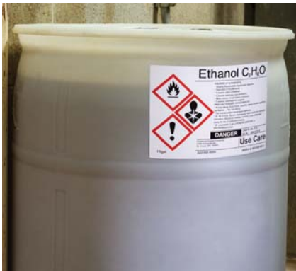
Étiquettes CLP avec des losanges rouge pré-imprimés
